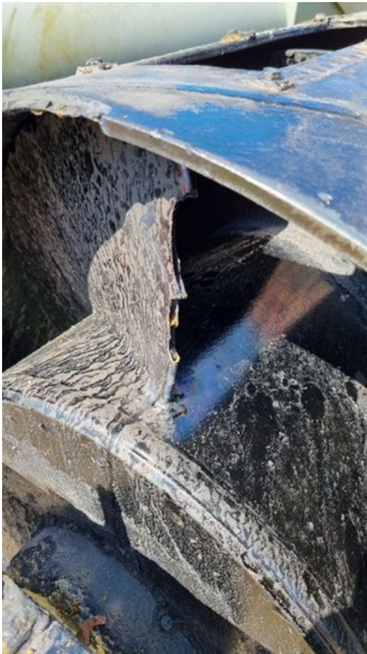
Abb: Korrodierte Schaufelblätter der alten Schneckenpumpen
